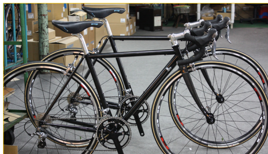
●2013年、JFF#501の最初の試作ではサイズごとに全て同じスペックで完成車に仕上げ、実証実験を繰り返しました。小さいサイズでもバランス良く90mm以上のステムを取り付けられる設計です。
