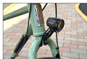
▲「SOMA JAWBONE」に装着のライトは過電圧保護装置内蔵の「JING YI 50Lux ダイナモライト」。高輝なダブル凸レンズでデイトランニングも備わる
