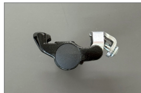
◀勿論ロープロファイル設計であり SPD タイプの超コンパクトな手のひらサイズ
