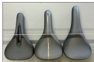
▲テストライドモデルを作りサイド面の形状や厚みを煮詰めていきます
