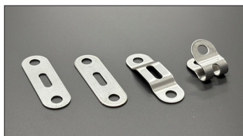
▶左から製造工程順に並ぶ。 型抜き→面取り→ 2段階に分けての曲げ加工が施される。
