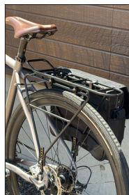
▲レンジャーキャリアに B-WeVer「ラインサイドバッグ」を取り付け。アジャスタブルレグにより 26-29" まで対応。
