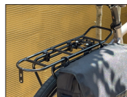
▲レンジャーキャリアに B-WeVer「ラインサイドバッグ」を取り付け。アジャスタブルレグにより 26-29" まで対応。
