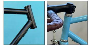
▲ヘッド周辺もシンプルが基本にあり、φ37mmヘッドチューブとφ31.8mmダウンチューブの構成でDi2やワイヤー変速に対応し、トップチューブはφ28.6mmでブレーキケーブルはフルアウターで内装トンネルを通過します。
