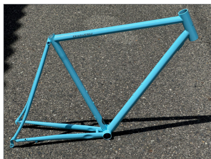
◀初期試作を塗装したもの。この段階からヘッドチューブ、ダウンチューブ、シートステーの設計を変更することになります。詳細は次回に。
