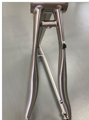
▶3A 2.5V チタン シームレスチューブを見事な溶接で継いでいます
