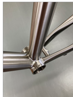
▶3A 2.5V チタン シームレスチューブを見事な溶接で継いでいます
