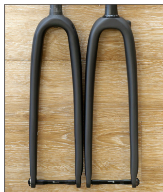
▲右の初期タイプから左の最終までに、下玉押しカーボン一体化・タイヤ通過部の形状変更・ケーブル入口の形状変更・3箇所のアイレット追加・スルーアクスルネジの左サイドへの変更などを行ない、振動減衰シート (VDS) も挿入されています。
