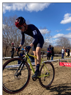
◀鈴木来入選手はプロトタイプからテストを続けブラッシュアップへの多数のアドバイスを享受、全日本 CX でも実戦で 1.25 のメリットを実証しました。写真は最終の京都での様子。最後の変更はフォークのレッグのある部分に極薄カーボンシート 1 枚を追加する、というものでした。結果は狙い通りでした。
