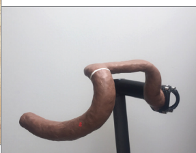
インダストリアルクレイで肉付きを整えていきます
