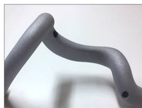
金属系の3Dプリンターを使用して形状を確認します
