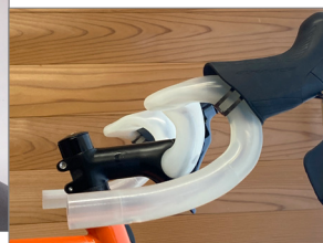
欧州の専門機関で内部を透視できる樹脂3Dを作成しケーブルの内部ルートを確認します
