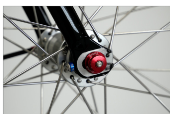
アルミのワッシャーによってオフセットを可変させます
