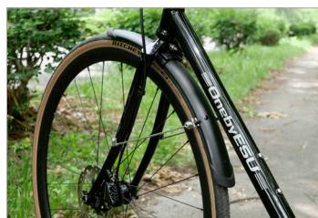
▲クラウンに貫通穴のあるフォークではスライド可能なブラケットにより取り付けます
