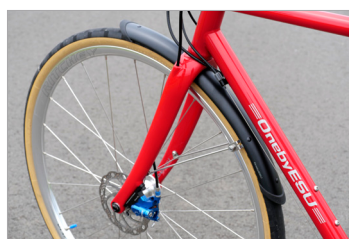
▲フォーククラウン下側にアイレットを設定したモデルは更にスマートな装着が可能です、下側アイレットタイプにはフェンダーに 5mm の穴を設け取り付けます
