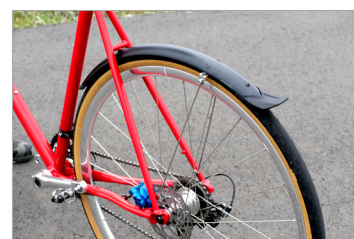
▲タイヤ外周の多くを覆い美しいものの、取付けの難しさや輪行など車輪を外した際に手間のかかるフルフェンダータイプや、美観に劣り抑止範囲も少ないものの、簡単装着など利便性の高い製品もありますが、ミドルフェンダーはある程度の抑止をしつつ美観を損ないません
