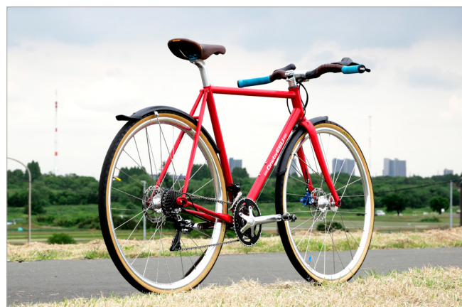
▲ JFF#701D に M サイズをセットし実測幅 34mm の 700C タイヤを装着
