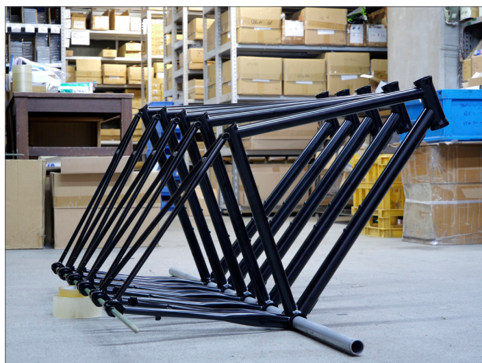
塗装前は黒い電着塗装状態で管理することで品質を保ちます。 455mm から 550mm まで5サイズ展開です。
