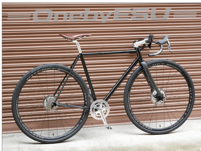
塗装前の 530mm サイズに 700×35C タイヤを仮装着した状態です。フロントフォークはデュアルオフセットの「OBS-RBD-TH 700C」をセット。スチールらしいシンプルな見栄えに、オールラウンドな雰囲気は漂うシルエットとなっています。
