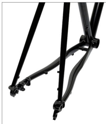
700×35C タイヤを許容するバック。S カーブ設計で縦と横に偏平化した独特のチェンステー。
