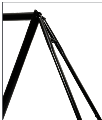
シートステーはチタンモデルと同じくブリッジ下から偏平加工を施し突き上げを緩和します。
