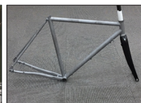
第1世代のスチールは外装ケーブル、フォークは他社メーカー品の 1-1/8" ヘッド、特に操舵性とリアとのバランスが改善点として浮かび上がってきました。
