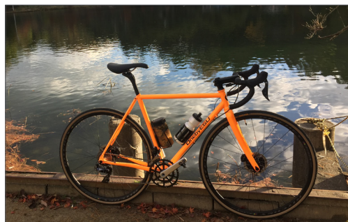
第1世代のスチールは外装ケーブル、フォークは他社メーカー品の 1-1/8" ヘッド、特に操舵性とリアとのバランスが改善点として浮かび上がってきました。
