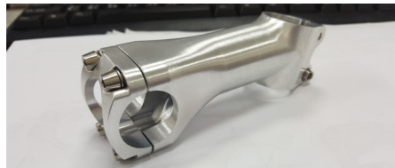
ヨゼフシステム 1インチモデル最初の アルミ切削プロトタイプ
