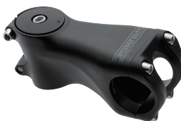
レンジャーシステム オフロード向けモデルは 専用トップキャップで トップがフラットに
